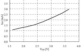
5052HxP, f<sub>OSC</sub>=80MHz, T<sub>a</sub>=25°C, no load
