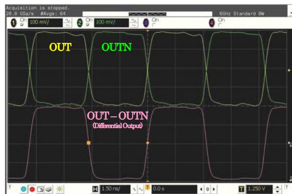
A2 version,  $V_{CC}=3.3V$ ,  $T_a=25^\circ C$
