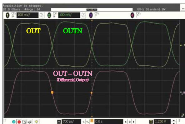
A1 version,  $V_{CC}=3.3V$ ,  $T_a=25^\circ C$
