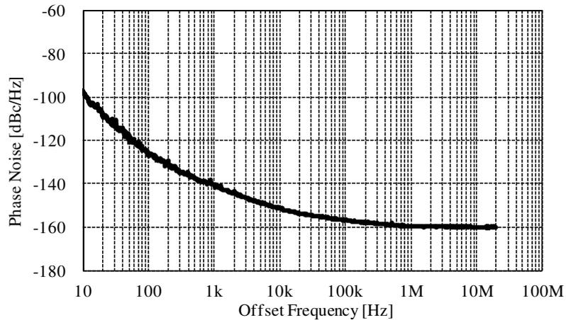
5058Hx1, f<sub>OSC</sub>=49.15MHz, V<sub>DD</sub>=1.8V, T<sub>a</sub>=25°C
