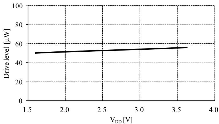
5058HA1,  $f_{OSC}=49.15\text{MHz}$ ,  $T_a=25^\circ\text{C}$
