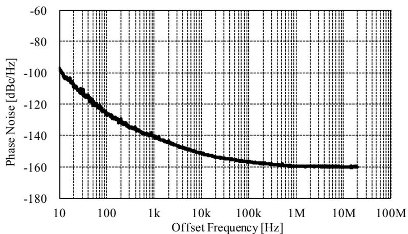
5058HA1,  $f_{OSC}=49.15\text{MHz}$ ,  $V_{DD}=1.8\text{V}$ ,  $T_a=25^\circ\text{C}$
