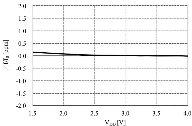
5058HA1,  $f_{OSC}=49.15\text{MHz}$ ,  $T_a=25^\circ\text{C}$ , 3.3V std.
